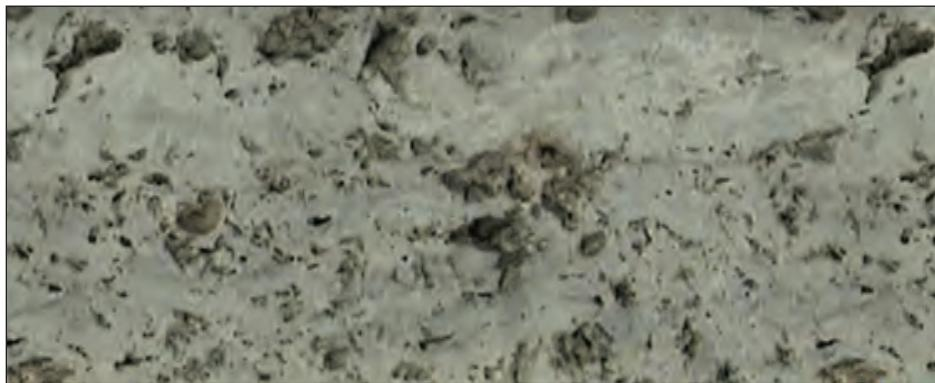
▲ 碳酸盐岩的复杂性。碳酸盐岩基质通常比较复杂，它们由不同含量的石灰岩、白云岩和其他矿物组成。孔洞相可成为碳酸盐岩储量的重要组成部分。与那些仅具有基质渗透性的井相比，通过裂缝网络中孔洞间接接触保持连通的井的产能要更高。（图中岩心切片照片经Whiting石油公司许可后使用）。
