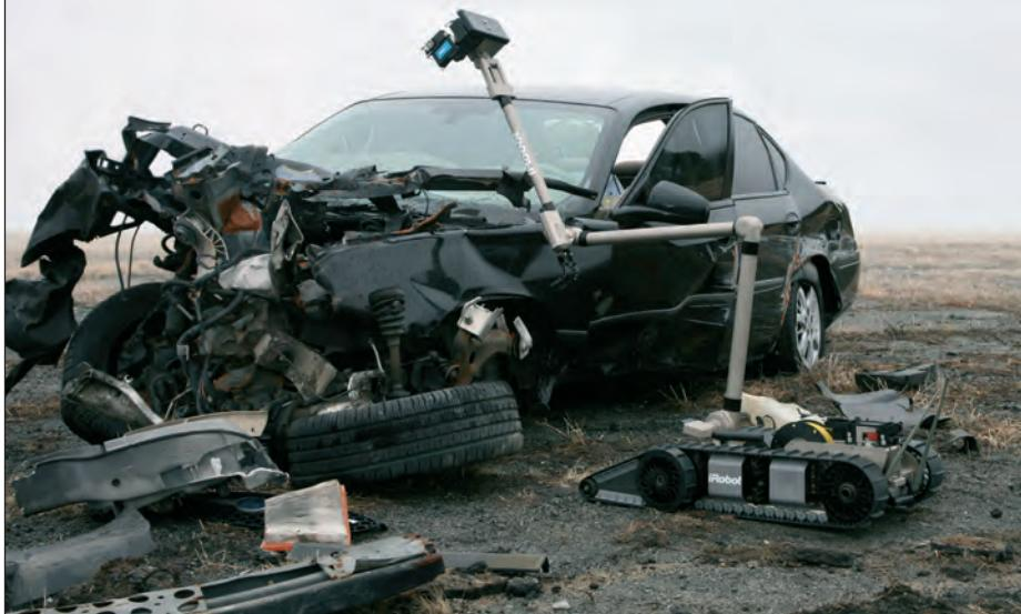
▲ 机器人侦查兵。诸如图中所示的PackBot设备是第一代广泛应用于军事作业的机器人。操作员可通过远距离监视和检查，在安全的距离评价潜在危险。（图片由iRobot公司提供）。
