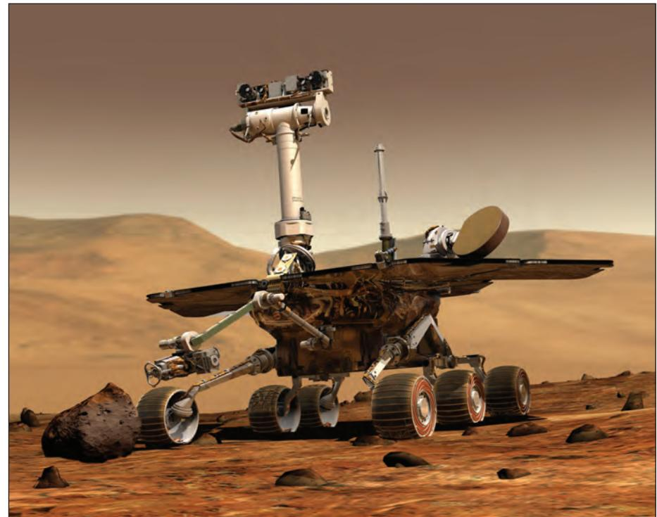
▲ 机器人地质师。机器人地质师以火星车的形式探测火星表面。该火星车装配有能够像人一样以肘部和腕部移动的机械手，可在岩石和土壤上放置各种仪器，进行测量。这些仪器包括用于分析周围环境的热发射分光仪、用于识别含铁矿物的 Mössbauer 分光仪、用于对采集样本进行元素分析的阿尔法粒子 X 射线分光仪、以及用于提供发送回地球的高分辨率图像的显微成像仪等。由地球上的一个天线网确保通信，并由两个绕火星运行的航天器向地球传送信息和向火星车直接发送控制信号。“勇气号”火星车在 2010 年 7 月失去联系，至此时它已工作了近 7 年，可能丧生于火星恶劣的冬季环境。另一台火星车，“机遇号”，继续执行探测任务，在 2010 年 9 月 16 日，该火星车移动了约 81 米 (265 英尺)。自 2004 年 1 月着陆以来，“机遇号”在最初计划为 3 个月的航天任务中走完了超过 23 公里(14.3 英里) 的路程。(根据 NASA 网站的资料改编：<http://marsrovers.jpl.nasa.gov> (2010 年 9 月 20 日浏览)。图像经许可后使用)。
