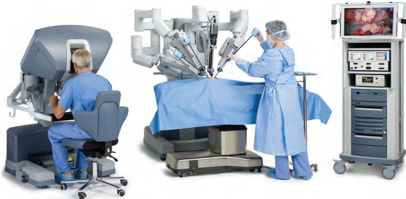
▲ 遥控外科辅助手术机器人。SAR（正如图中所示的da Vinci系统）实现了机器人技术在手术室的成功应用。外科医生（左）坐在计算机控制台前，遥控操作机械手。患者（中）在辅助人员的帮助下接受手术。外科医生的手部动作被感知并以电子的形式转化成手术台上的微移动。与传统的外科手术方法相比，这种方法能够放大并检查目标部位，可帮助医生更好地控制手术过程。远距离观测（右）提供了额外的视觉信息，以用于培训和专家会诊。（图片由直觉外科公司提供，2010年版权所有）。
