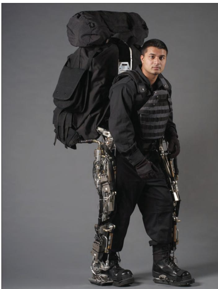
▲ 助力行走。利用由加利福尼亚大学伯克利机器人和人体工程实验室开发出的仿生物BLEEX，使用者可在极端负荷下移动，而仅感受到几磅的负荷。该设备与类似设备在设计上增强了强度与耐久性，可能会用于帮助残疾人士获得移动能力。（图片由加利福尼亚大学伯克利分校的H. Kazerooni博士提供，图片的使用得到许可）。
