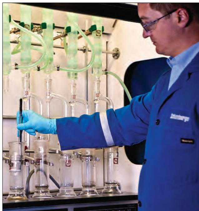
▲ 迪安斯塔克装置。一名岩心分析员将岩心塞入样品测量装置中（照片）。迪安斯塔克装置（左侧）的典型配置包括一个电加热元件，或加热罩、一个带萃取室的沸腾烧瓶、一个样品套管或承托网、一个脱水器或标定的接收管以及一个冷凝器。迪安斯塔克方法可以量化地测量从岩心中萃取出来的水的体积，各个样品在独立容器中分别清洗。
