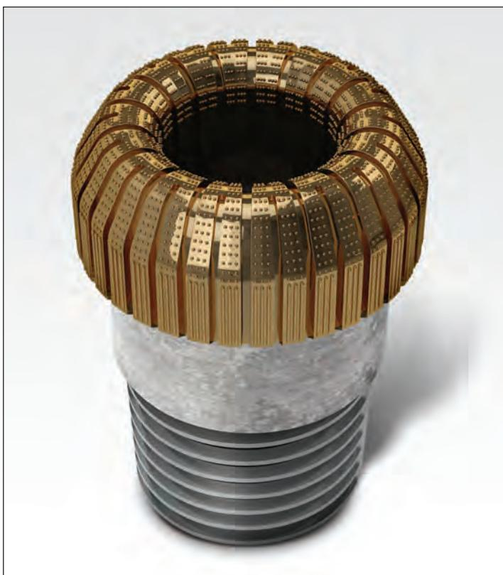
▲ 取芯钻头。图中聚晶金刚石复合片钻头采用了固定牙轮设计，可以保持不触碰井孔中心。该钻头可以钻出一个圆柱状地层芯，岩心穿过钻头中央后被夹持在井下钻具组合中。
